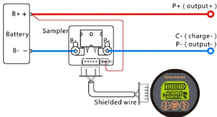
Le shunt et le cordon sont livrés avec l'indicateur | la longueur du cordon est de 50cm
